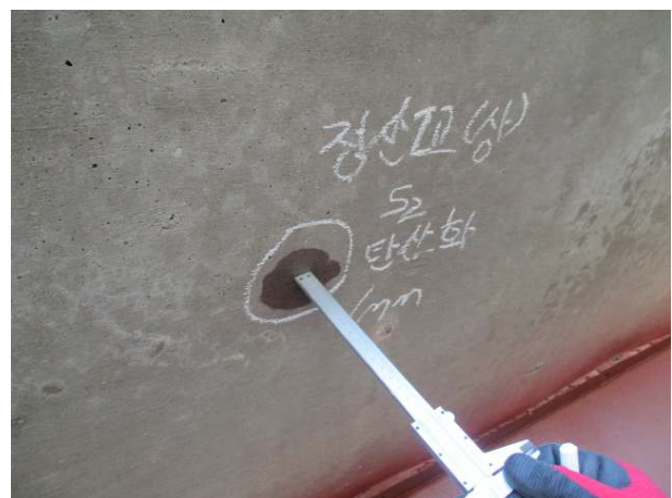
콘크리트 탄산화시험(탄산화 깊이측정)
